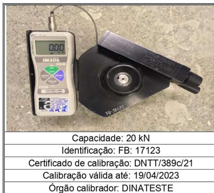
Figura 1 - Descrição e rastreabilidade dos equipamentos de tração
