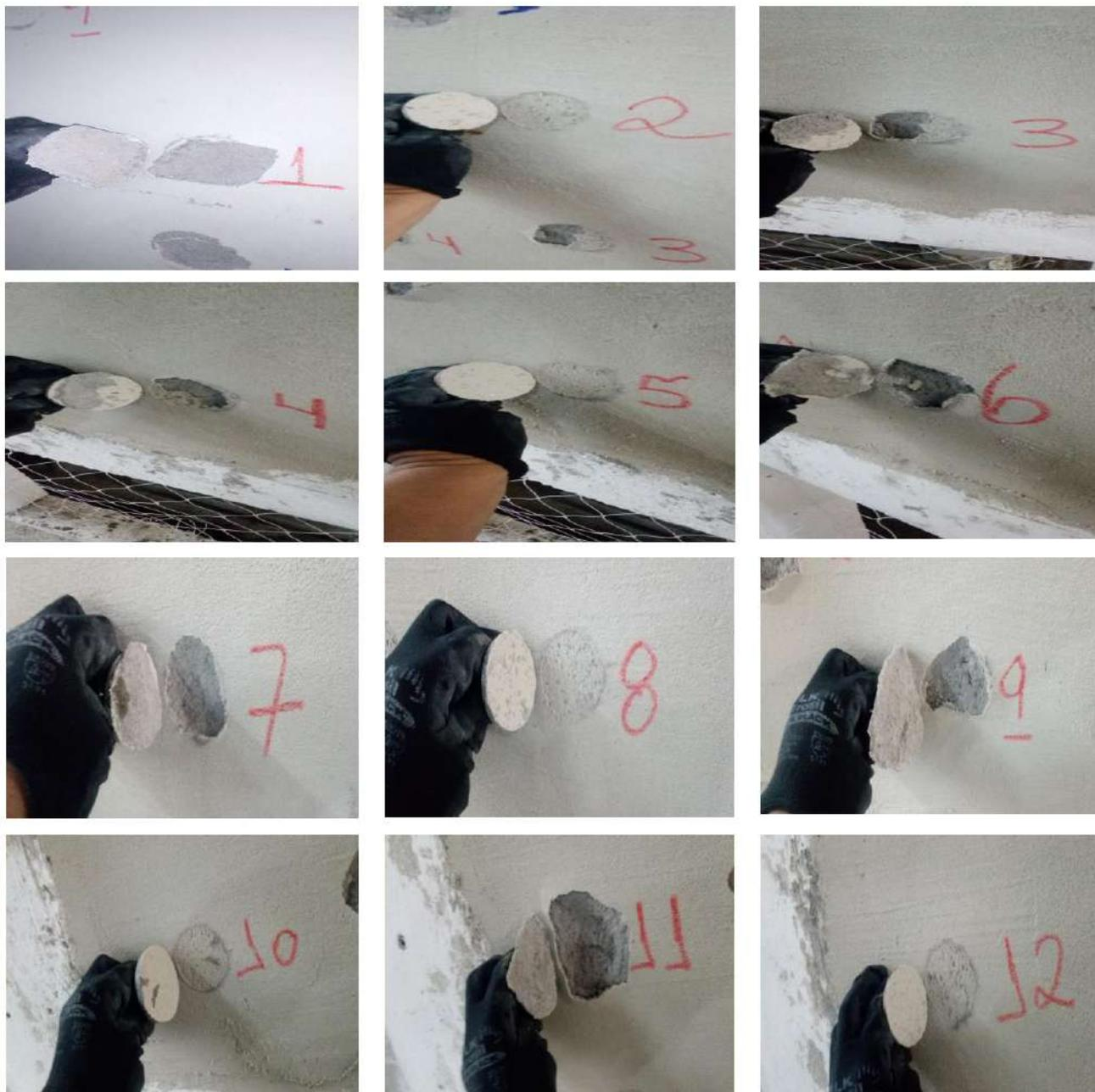
Figura 4 – Corpos de provas do Paine 3 após a ruptura.
